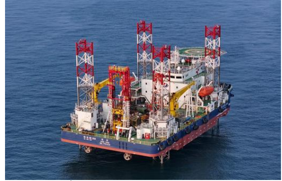
แพลตฟอร์มการสำรวจแท่นเจาะแบบ Jack Up โครงสร้าง 3 ขา ลึกลงไป 80 เมตร
